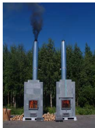
Sichtbarer Unterschied: Links ein Speicherofen mit herkömmlicher Verbrennung, rechts sorgt der „Rost des Goldenen Feuers“ für eine drastische Reduzierung von Emissionen.
